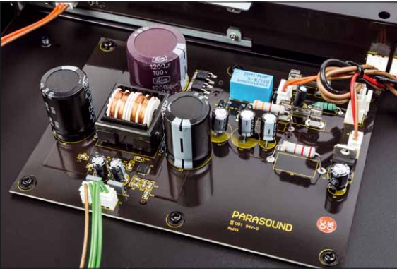
Die Netzteilplatte samt Spule zur Stromreinigung. Sauberer und eleganter kann man das kaum machen
