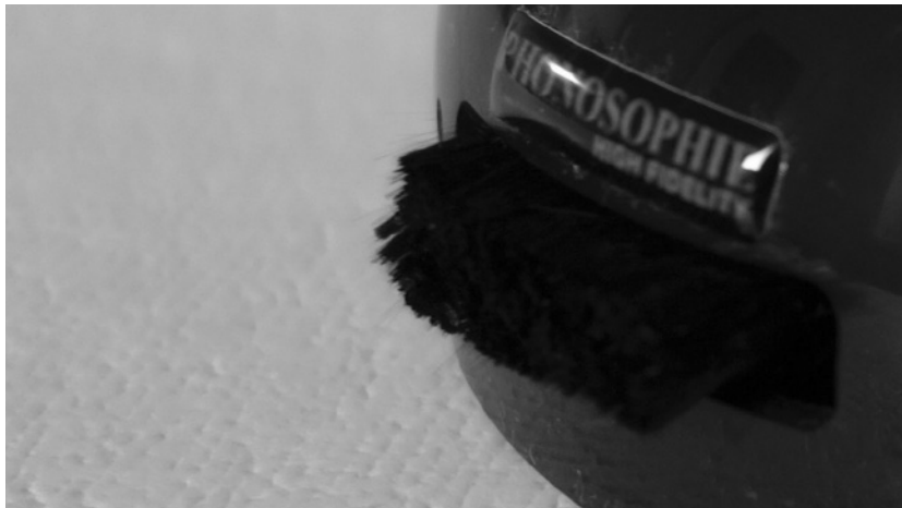
Aus der kleinen Öffnung mit der Carbonbürste treten die negativen Sauerstoff-Ionen aus.
