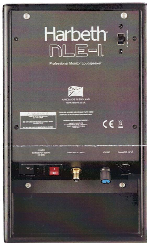
Das abgeschrägte Anschlussfeld mit dem stufenlosen Regler für die Eingangsempfindlichkeit findet sich auf der Rückseite, alles ist gut erreichbar. Der schlichte Schiebeschalter zur Klangabstimmung hat es in sich: Dank DSP-Technologie verleiht die „B“-Stellung dem NLE-1 mehr Tiefbasskompetenz.
